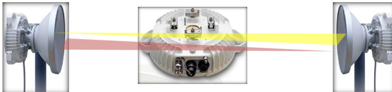
Radio Full Duplex Bidirectionnelle, Orthomode, la seule technique sans aucune latence, comparable à la fibre optique Full Duplex et garantissant des images de Haute Définition sans saccades ni pixellisations.
