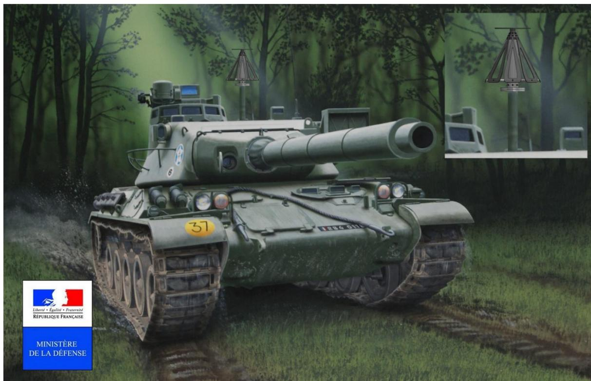
*Intégration d'un système Video MobiRake sur Char AMX avec antenne Discone 200 MHz 1 GHz*
