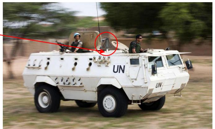
L'antenne Discone, couplée à un filtre Multiplexeur permet d'assurer toutes les liaisons Radio et Vidéo des véhicules de 200 Mhz à 1 Ghz ou de 400 Mhz à 2 Ghz.
